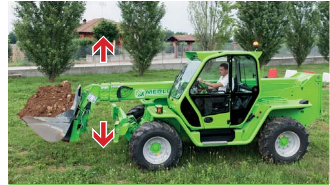
BSS sospensione Idropneumatica del braccio (opt - 12/13 metri). Inseribile dall'operatore, velocizza i trasferimenti e salvaguarda il carico e migliora la produttività. Si disattiva a velocità <3 km/h per mantenere la massima precisione operativa
