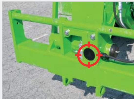
Sensore posto sulla zattera
